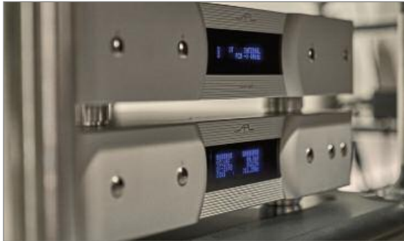
Die Quelle: APL DNP-SR Netzwerkspieler und DSD-AR D/A-Wandler. Trotz der übertrageregekoppelten Ausgangsstufe erwies sich das zusätzliche Einschleifen der dazu gehörende Vorstufe PRE-MR in Verbindung mit Avantgardes ITRON mehr oder weniger als Pflicht
